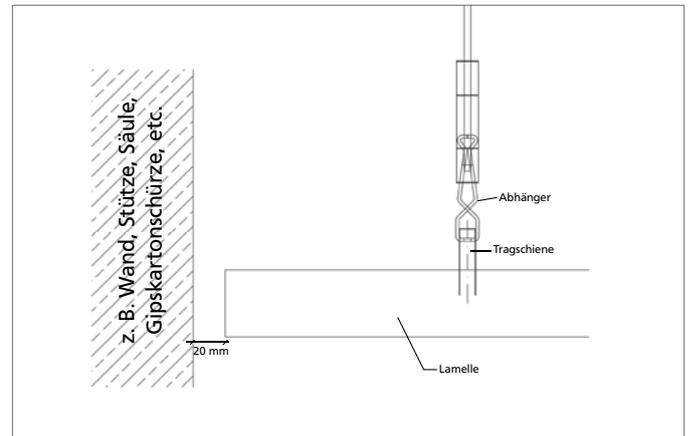
Die Tragschiene sollte ebenfalls mit Abstand (10 – 20 mm) zur Wand montiert werden. Das gesamte System muss freitragend im Raum hängen. Von einer Fixierung an angrenzende Bauteile wird dringend abgeraten. Die Tragschiene muss mind. 5 – 10 mm über der letzten Lamelle stehen um diese voll aufzunehmen.
